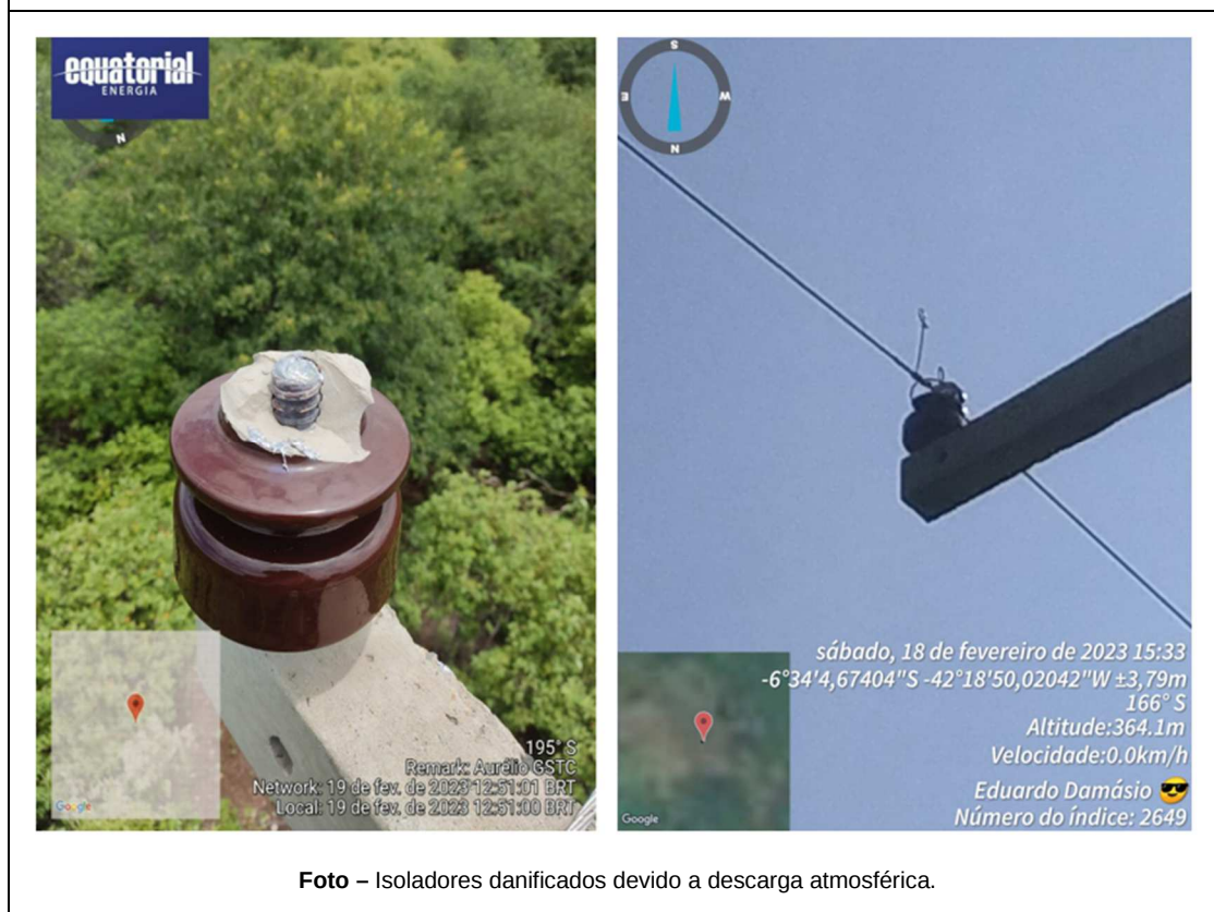
Foto – Isoladores danificados devido a descarga atmosférica.
