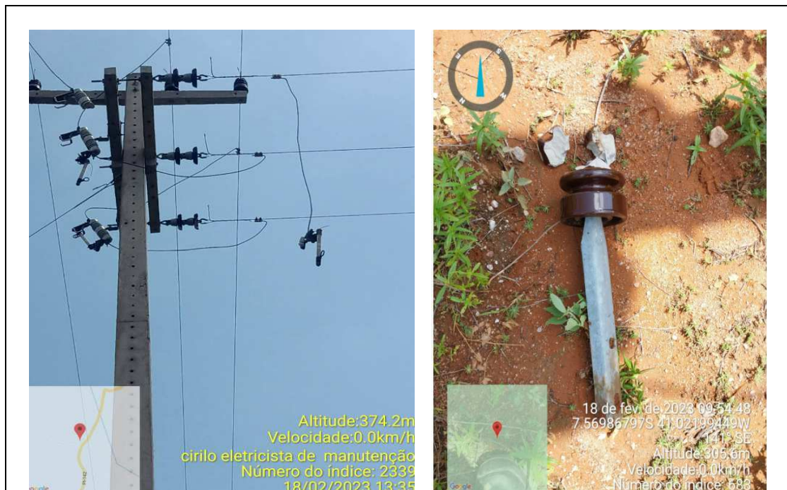
Foto – Isoladores danificados devido a descarga atmosférica.
