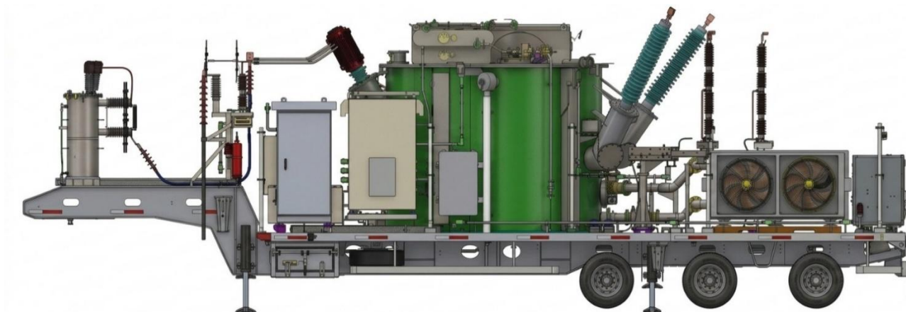
Desenho 1 – Transformador Móvel
