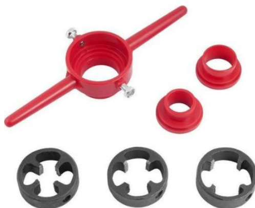
Quadro 1 - Tarraxa para Tubo de PVC - Dados Dimensionais
