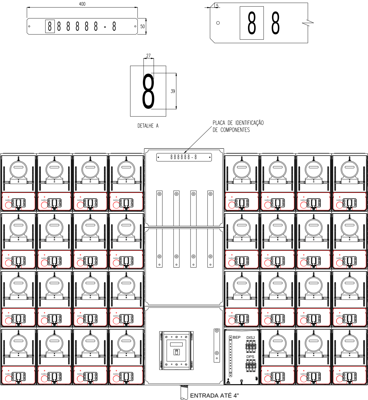
DESENHO 31 – Placa de Identificação do Transformador no Centro de Medição
