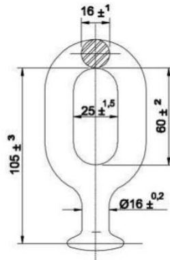
Desenho 1 – Engate Elo Bola – Detalhes Construtivos
