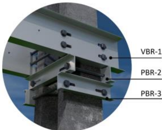
Instalação em Bancos de Reguladores
