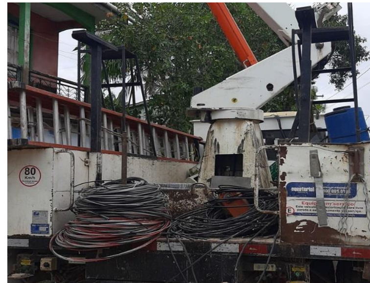
Figura 01: Exemplo de carroceria com materiais e ferramentas dispostos de maneira desorganizada
