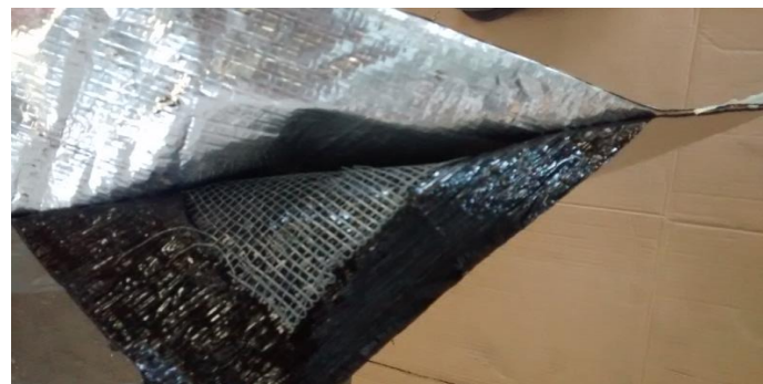
Detalhe de montagem da tela ciranda entre as duas mantas
