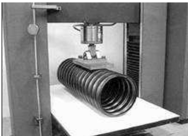
Figura 1B – Ensaio de Compressão Diametral (mesmo equipamento do ensaio de impacto)
