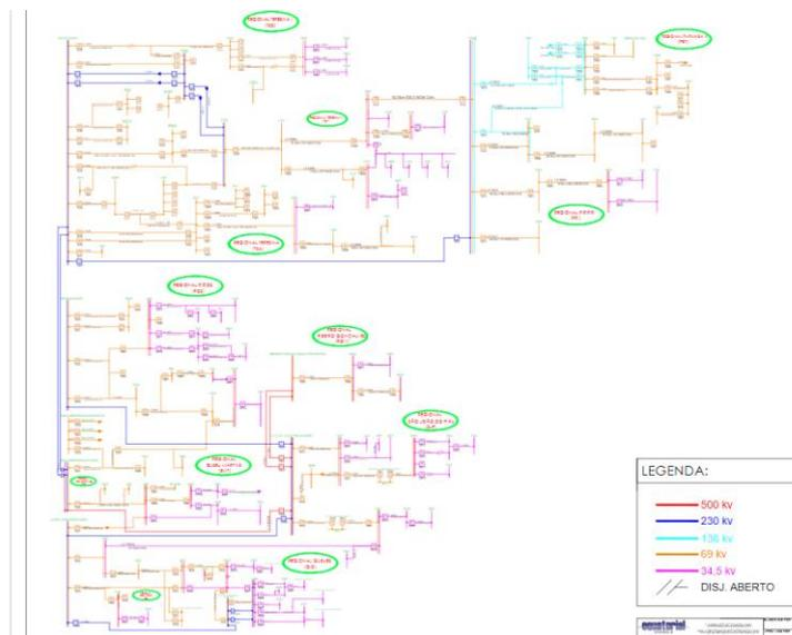
Figura 3 – Configuração do sistema de 69kV Região
